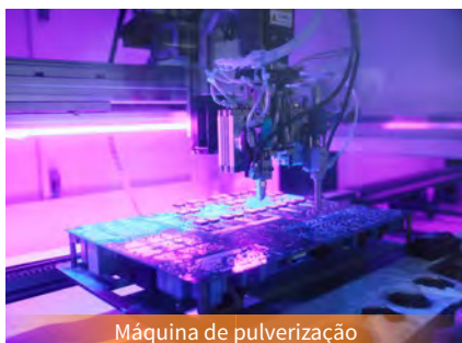
Máquina de tecnologia de montagem superficial (SMD)
